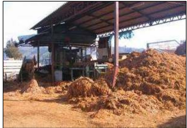
樹皮は破碎・乾燥して水分量を下げ ボイラ燃料として活用
